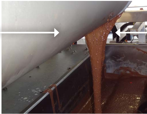
2. Mischanlage über den Gießformen für die Zugabe von: - Nüssen, Salz, anderen Partikeln - Flüssigen Zusatzstoffen
